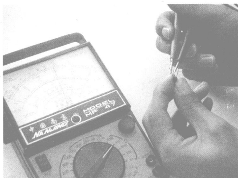
图 1—12 用万用表测试确定三极管的基极和管型
