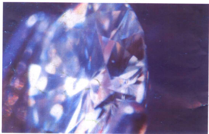
从圆钻型合成碳硅石的冠部斜视亭部时所见到的重影
