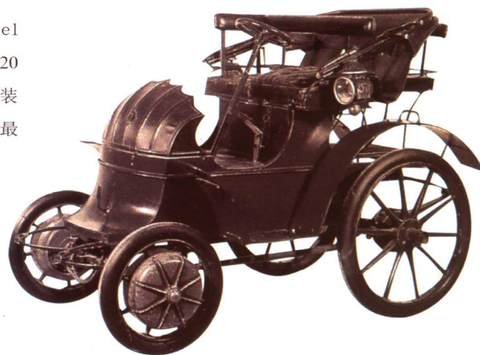
洛赫内-波尔舍(Lohner-Porsche)电动车 1900 洛赫内-波尔舍的电动车给人最大的印象是凸出的前轮毂,在那里面安装了两个电动机,功率2.5马力,最高时速能达到50公里。
