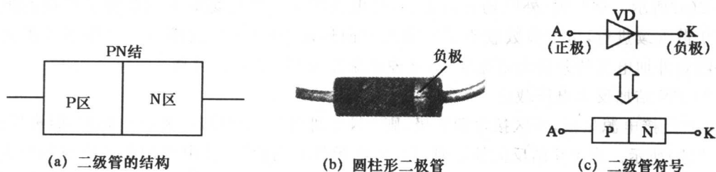
图 1-3 二极管的结构和符号
