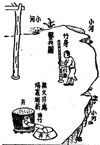
四川的鹽井（採自“天工開物”） 四川的火井（採自“天工開物”）
