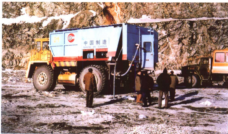
► “BCJ系列乳化炸药现场混装车”在俄罗斯卡其卡纳尔铁矿采场
