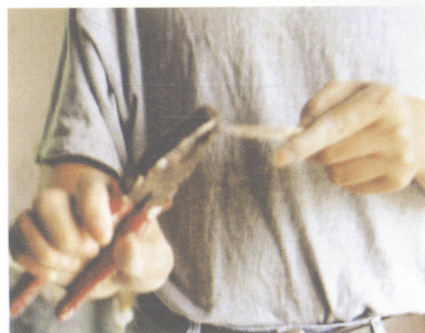
钢钳调整刀的弯曲度(1-28)
