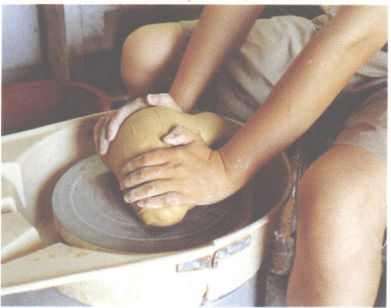
双手将泥块压成提拉状 (1-2)
