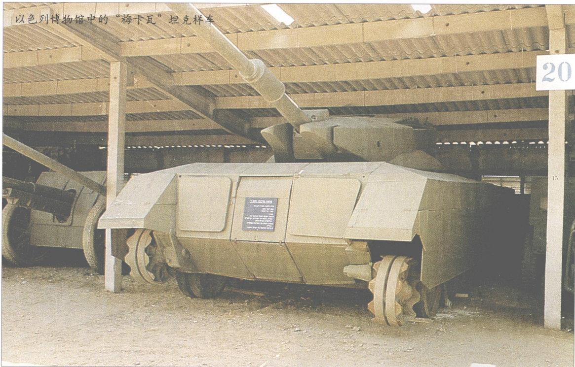
最初“梅卡瓦”坦克样车的底盘是在逊丘伦坦克底盘上改进而成的，上面安装了M-48坦克的炮塔。
