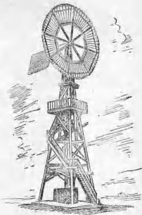
圖 1 “В.И. 達維多夫型”多叶式風力發动机 (1896年)。
