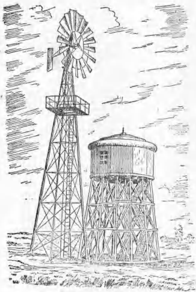
圖 4 現代的风輪直徑為5公尺的“TB-5”型 低速多翼式風力發動機。
