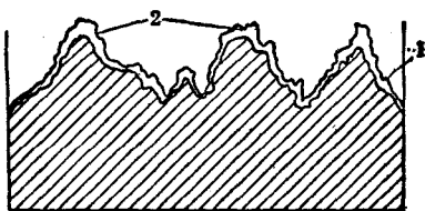
圖 1. 電鍍層在加工表面上的特性 1-鍍層； 2-樹枝狀突起。
