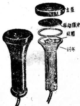
图 18 手持式受话器内部构造图
