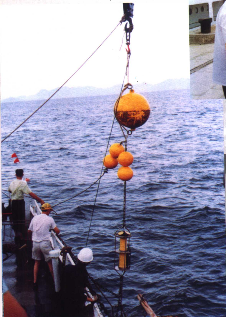
ADCP/CTD 锚定测量系统布放
