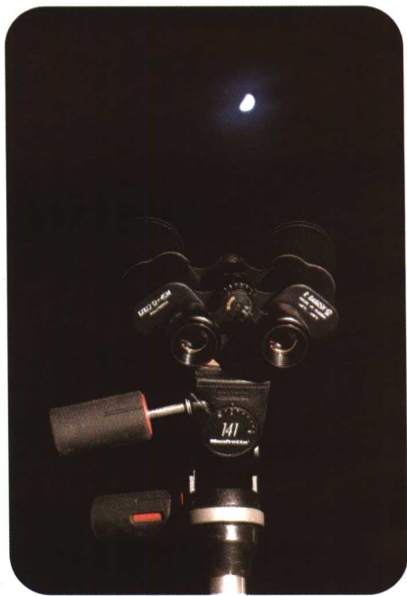
上图 这是一台 25×100 的双筒望远镜，固定在三脚架上确保稳定，有助于观测时获得最佳的光学效果。
