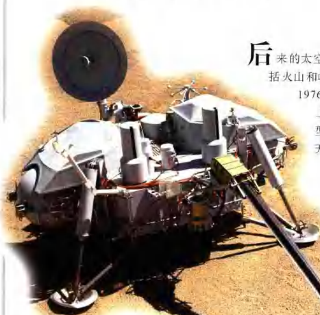
“海盗”号探测器搭载了人造卫星部分。能从上方确定火星的位置。每颗人造卫星上都有一个着陆器，可以接触并在火星表面平坦的地方登陆。
