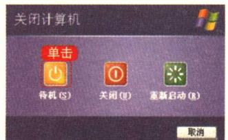
桌面上出现一个“关闭计算机”的对话框，选择“待机”选项后，系统将保持当前的运行，计算机将转入低功耗状态，当用户再次使用计算机时，在桌面上移动鼠标并输入密码即可恢复原来的状态。
