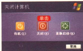
桌面上出现一个“关闭计算机”的对话框。选择“关闭”，系统将停止运行，保存设置退出，并且会自动关闭电源。选择“重新启动”系统将关闭并重新启动计算机。
