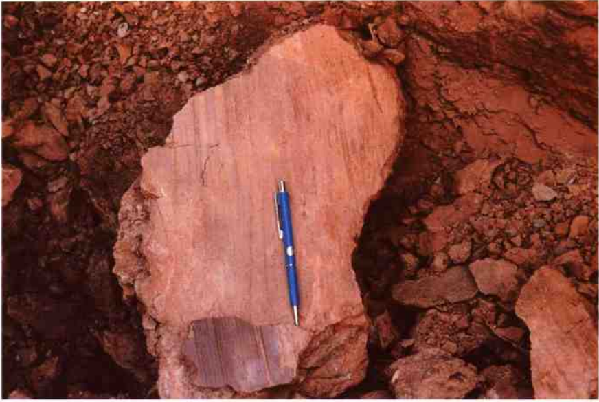
照片 1—3 滑动面上的滑动擦痕
