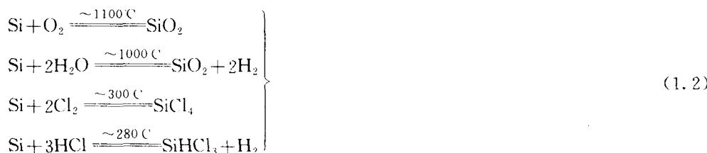
(1.2)式前两个反应是硅平面工艺中在硅表面生成氧化层的热氧化反应，后两个反应常用来制造高纯硅的基本材料—— $\text{SiCl}_4$ 和 $\text{SiHCl}_3$ 。 $\text{SiO}_2$ 十分稳定，这一特点使得 $\text{SiO}_2$ 膜在器件工艺中起着极为重要的作用。PN结受到 $\text{SiO}_2$ 膜的保护提高了器件的可靠性。在平面工艺中， $\text{SiO}_2$ 膜是MOSFET器件结构的组成部分；在扩散工艺中成为有效的掩蔽层。由于 $\text{SiO}_2$ 膜容易热氧化生成以及可以通过化学腐蚀选择性去除，因此，能够使用光刻方法实现器件小型化，使精细结构变成现实。
