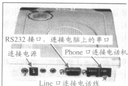
图 1-8 外置式调制解调器
