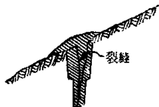
图1 裂縫开挖和填筑方法
