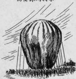
正在裝氣的平流層氣球球殼
