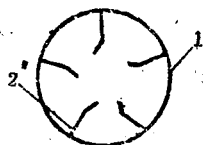
图3 电极外壳示意图 1—电极铁壳；2—翅片
