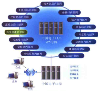
中国电子口岸网络结构图
