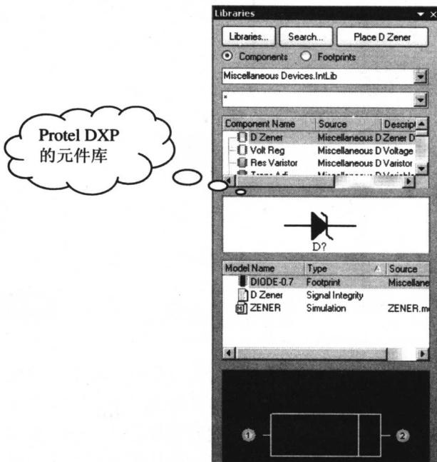
为了保证用户能够继续使用已有资源，在 Protel DXP 中，用户仍能够继续使用独立的原理图符号库、PCB 封装库以及 Protel 99SE 的导出库 (\*.Lib)。同时，用户还可根据需要创建自己的原理图符号库、PCB 封装库和元件集成库，并且原理图符号库在功能上已完全等同于集成库。
