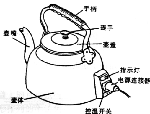
图 1-2-3 自动控温电水壶结构图
