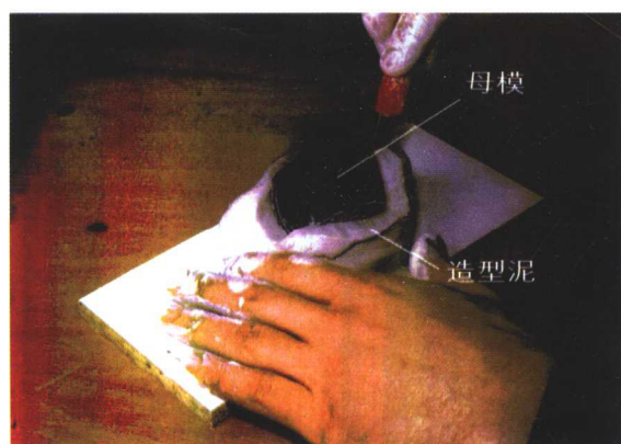
彩图 3 将母模埋入造型泥中
