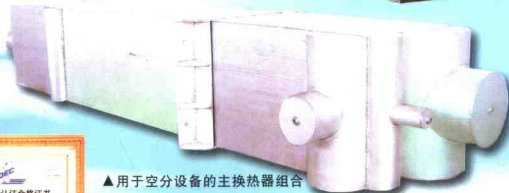
冷凝蒸发器 ▶ (6000m 3 /h 空分设备用)
