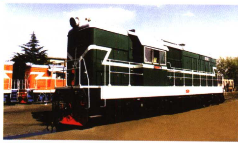
GK1E31 型工矿液力传动内燃机车
