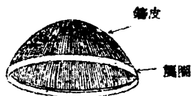
圖 4 淘盖 頂高 1 尺 5 寸 口徑 2 尺 7 寸至 2 尺 8 寸
