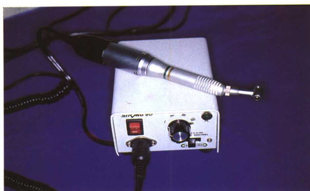
图 3-2. 根管治疗用马达及反向弯机头手机。与低转速马达相连接的反向弯机头手机
