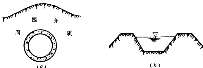
图0-3 隧洞和渠道 (a) 土隧洞; (b) 土渠道
