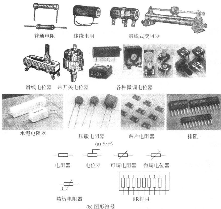
图 1-1 部分电阻器外形及其图形符号
