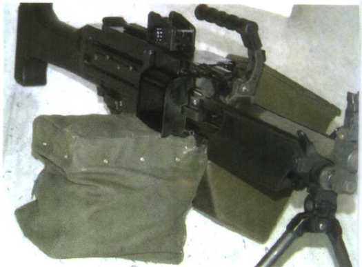
MG4轻机枪在车辆或直升机等载具上使用时，可在抛壳口下挂上一个弹壳收集袋。
