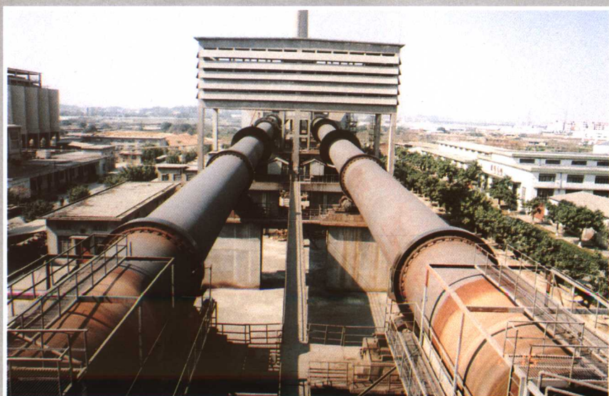
► 广州石井水泥公司二分厂的两条湿法回转窑（90年代）。
