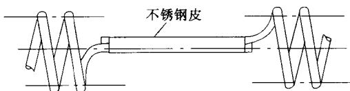
图 1-11 包不锈钢皮冲压连接法
