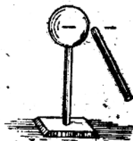
第7图 球体电荷与带负电的小棒
