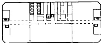
边核 + 分离核心型 / 新宿 Island Tower（住宅、都市整備公团 + 日本设计，1995年）：44层、钢结构。中央部之西北向配置着主核，长边方向的两端配置着副核。
