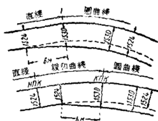
第5圖 軌距加寬速減距離的設置
