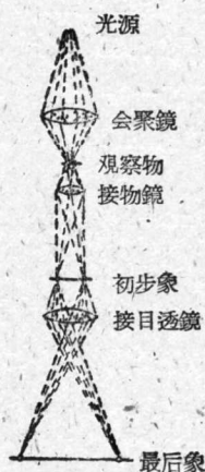
图3 投影式光学显微镜中光线的进路
