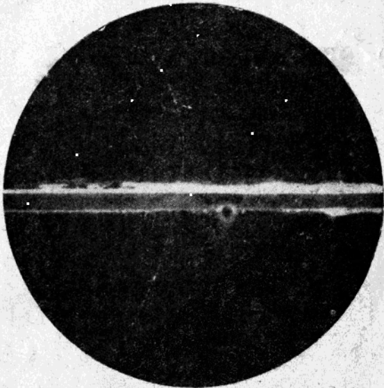
圖1-3 表明發現正子的一張照相。一只“63一百萬伏特”的正子通過一塊、6 mm 的鉛板後，成爲一只“23一百萬伏特”的正子。
