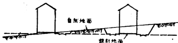
圖 2 在有坡度的地面取同一标高的情况
