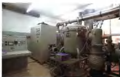
MOX 燃料研究用的中频感应真空烘结炉
