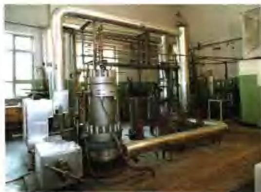
高温高压动水腐蚀实验回路
