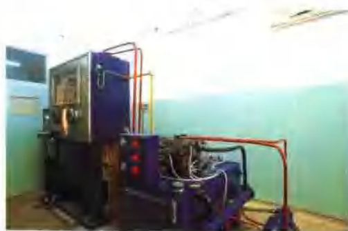
MOX 燃料研究用的粉末自动成型压机
