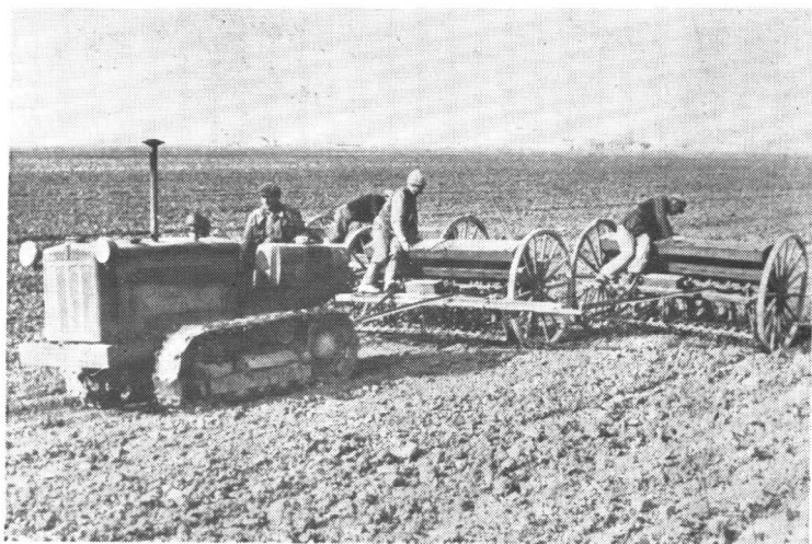
7. 羅馬尼亞的KD35号拖拉机，正拉着三架播种机在播种。
