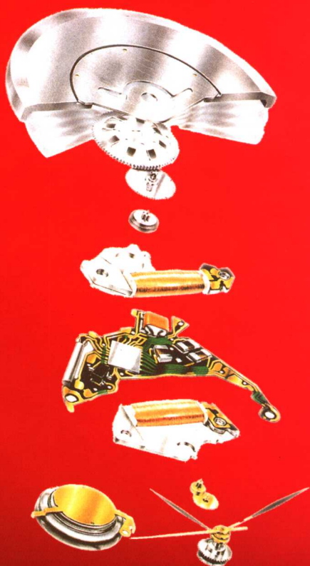
图 2-45-1 人工动能指针式石英表结构原理图
