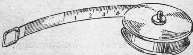
圖 4 皮尺。劃綫和檢驗用，測量精確度 1 公厘。
