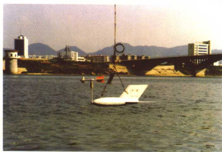
耒阳水文站缆道测流
