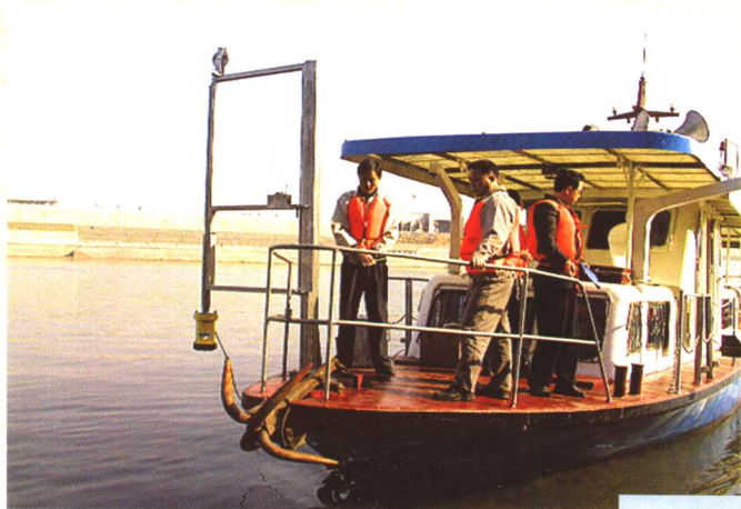
邵阳水文站采用多普勒剖面流速仪 (ADCP) 测流
