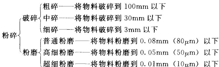
固体物料经粉碎后，内部晶体结构发生变化，表面能增大，其单位质量的表面积（比表面积）也增加，可以提高物理化学反应的速度，容易混合均匀，提高均化效果，并为烘干、储存和输送创造有利条件。
