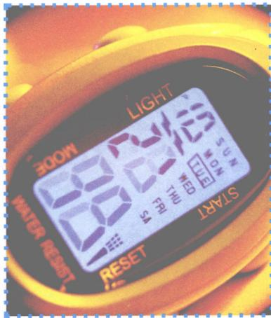
随着科技的进步，电子表应运而生。电子表的最大特点是使用方便，不用上“弦”。那么，为什么电子表不用上弦呢？在电子表的内部装上了电池，利用电能电子表可以正常的运转。如果电池没电了，换上一节新的，它就又可以走了。
