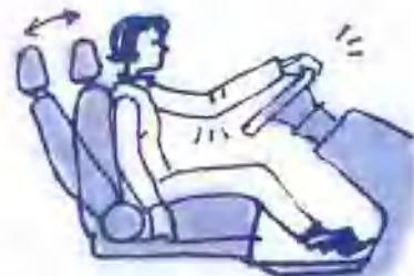
一只手放在方向盘的最上方(时钟12点)，进一步调整座椅靠背，使座椅靠背调整到紧贴到后背，肘部略微弯曲的位置
