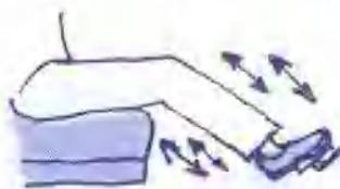
座椅调整的关键，是当右脚把制动踏板踩到底时，膝盖应呈微微弯曲状，并反复踩几次踏板调整
