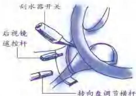
与转向盘连接的侧向或下侧，有一根调节转向盘位置的连杆(位置因厂商和车型不同而异)，操作连杆解锁后能调整高度
