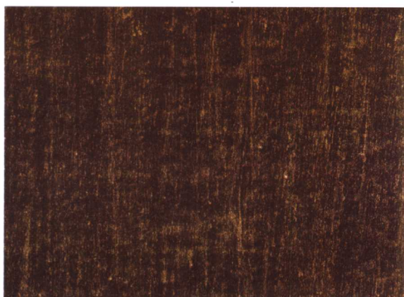
SB1-1 棕底扫红金，工艺流程：在已做好防锈涂装的产品上涂装 SB1，干燥后用油刷扫 60% 左右的红金，最后罩光（丙烯酸自干或双组分均可）。
