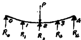
图4 求四孔梁的支点反力
